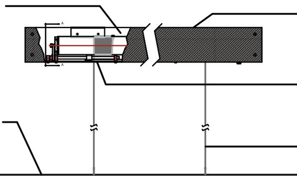
Ein Zusammenbau aus Aluminium sorgt für Sauberkeit und glattes Aussehen. Kann lackiert werden, um zur Farbe der Decke zu passen.
